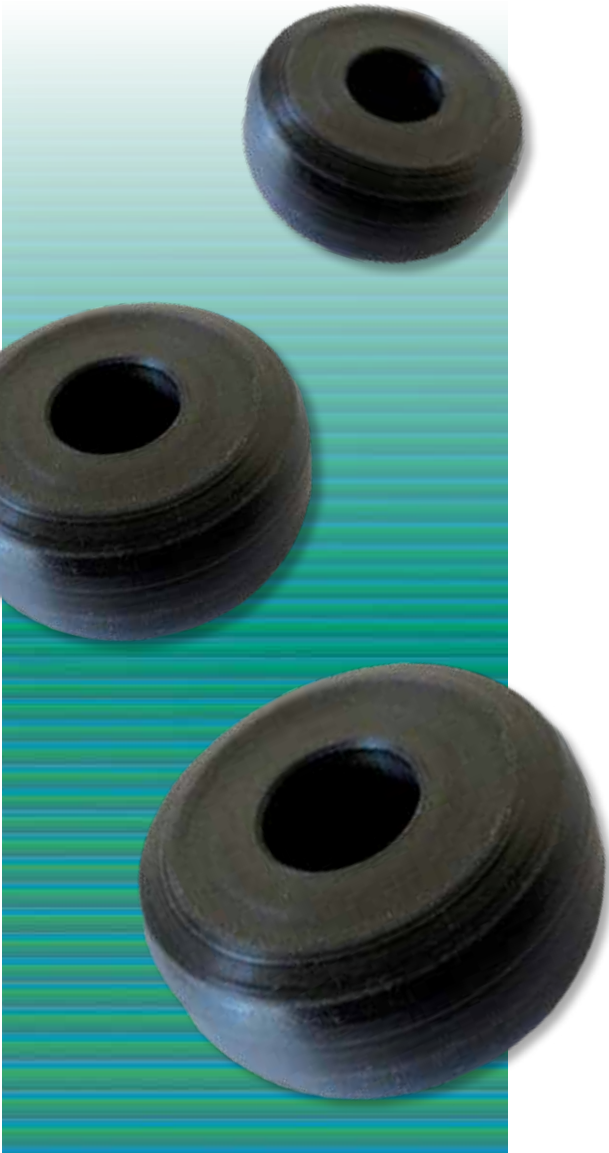
Pressendämpfer, TUBUS-Spezial-D00042, spanend hergestellter Prototyp, statische Kompression, v~70 mm/Min., 13.04.2011
