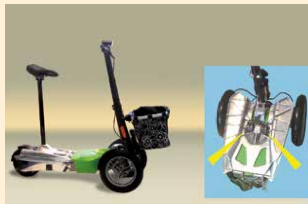
Strukturdämpfer erhöhen Fahrkomfort eines Elektro-Scooters
